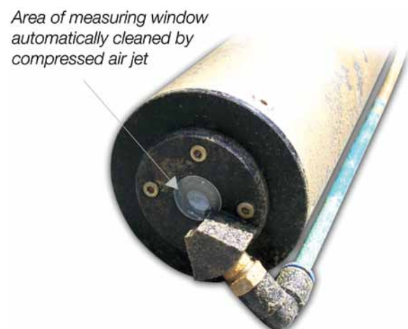
Figura 3. Cabezal de la sonda de aceite en el agua FP 360 sc con sistema de limpieza neumática...
